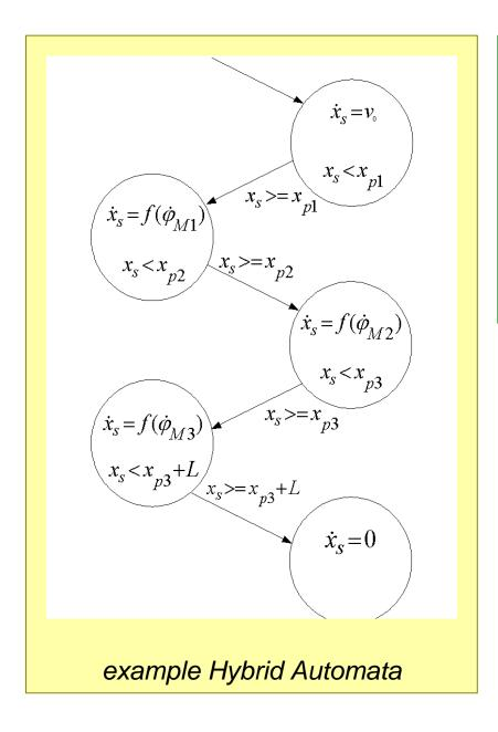
$$\dot{x}_{s}(t) = \begin{cases} v_{0} & \text{if} & x_{s} < x_{P1} \\ A_{1}x_{s}(t) + B_{1}u(t) & \text{if} & x_{s} \ge x_{P1} \land x_{s} < x_{P2} \\ A_{2}x_{s}(t) + B_{2}u(t) & \text{if} & x_{s} \ge x_{P2} \land x_{s} < x_{P3} \\ A_{3}x_{s}(t) + B_{3}u(t) & \text{if} & x_{s} \ge x_{P3} \land x_{s} < x_{P3} + L \\ 0 & \text{if} & x_{s} \ge x_{P3} + L \end{cases}$$
